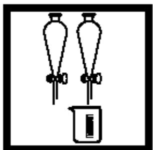
17.当计时器鸣叫时，分别将两个漏斗中的下层水层分出，弃去。
