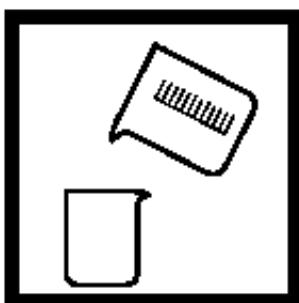
1. 在400 mL大口杯中收集200-mL样品。看需要，用1.0N的HCl或1.0N的NaOH调节pH到7.6。
