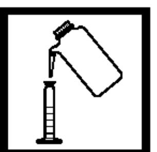
18. 加入去离子水到量筒，使体积刚好为25Ml。盖好盖子，混合。标记量筒为“试剂空白”。
