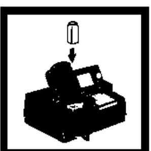
9. 按ZERO, 屏幕显示: 0.00 mg/L PO<sub>4</sub><sup>3-</sup>。
