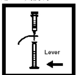
17. 转动阀门的杆，转到抽吸档(向左)，缓慢将洗提液推过LC柱(至少要30秒)。用一个25mL高筒量筒收集洗提液。
