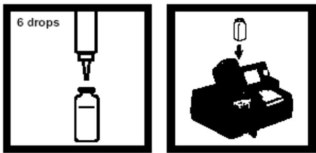
17. 取出比色瓶，加入6滴pPb-6 脱色溶液到比色瓶中，充分混合。
