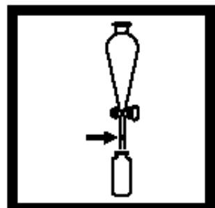
11. 当计时器鸣叫时，等待溶液分层。在漏斗的出液管中塞入豌豆大小的棉花，分出氯仿层（下层）到一个比色瓶中（待测样品），盖好盖子。
