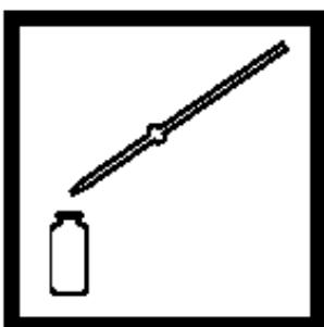
5. 取出0.5mL过滤液或上清液到另一个25mL的干燥比色瓶中(待测试样)。
