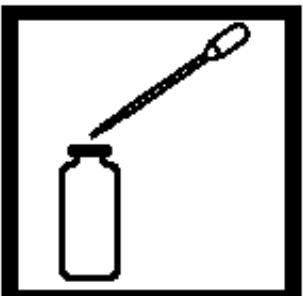
6. 分别精确加入0.5 mL DEHA试剂2溶液到每个比色瓶中，混合，将比色瓶放于黑暗处。
