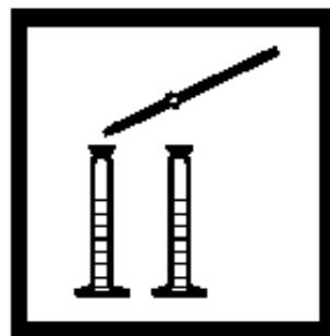
11. 分别移取1.00 mL Nessler's 试剂到量筒中，盖好盖子，混合。溶液不应浑浊。浑浊会引起错误结果。
