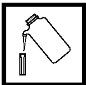
1. 往一个1-cm比色皿中装入去离子水（空白试样），用纸巾擦去瓶外的污迹和指纹。注：不要接触比色皿透明侧。
