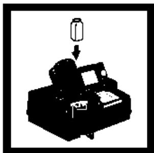
9. 将待测样品放入比色瓶槽，关上遮光盖，屏幕显示 $\text{PO}_4^{3-}$ 的含量，单位为mg/L。
