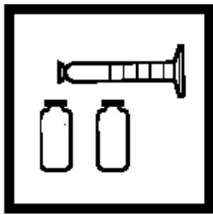
9、将二量筒内溶液分别倒入二个比色瓶内。
