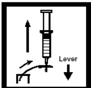
10. 通过管道将余下的试剂空白吸入注射器，然后吸入少量空气，超过 30cc 刻度线。
