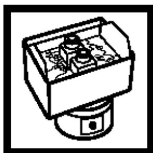
8. 将两个比色瓶放入沸水浴中。注: 可以在600mL的大口杯中加热比色瓶。
