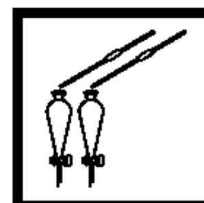
7. 分别加入5 mL Hardness 1 Buffer到每个分液漏斗。盖好盖子，混合。
