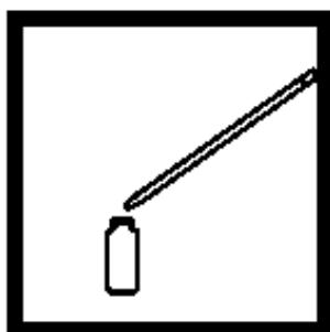
7. 加入0.2mL的19.2N的硫酸标准溶液到每个比色瓶中。旋转混合。
