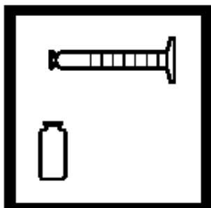
6. 往一个比色瓶中装入混合液到10mL刻度 (空白试样)。加入一包硫代硫酸钠粉包, 混合30秒使粉末溶解。
