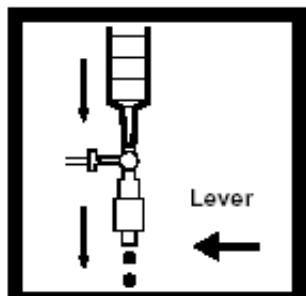
12. 转动阀门的杆，转到抽吸档(向左)，缓慢将溶液推过LC柱(至少要15秒)。弃去溶液。参阅图2。
