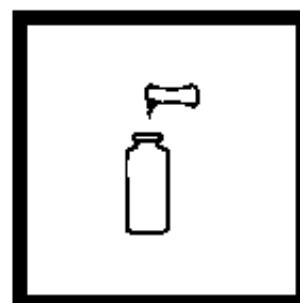
8. 加入一包NitriVer 3亚硝酸盐试剂粉包到比色瓶中(待测试样),盖上盖子。
