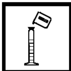
4. 在另一个50mL混合量筒中精确量取25mL不含甲醛的水（空白试样）。
