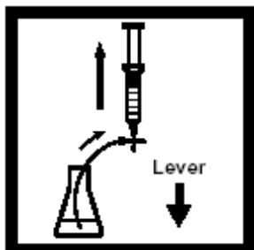
21. 将阀门转再到吸气档（向下），重复步骤8到20，用缓冲样品代替试剂空白。标记玻璃仪器为“样品”。
