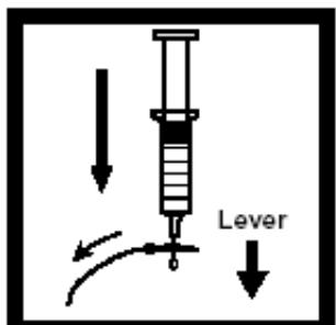
9. 摆动注射器来冲洗注射筒，上下推动活塞几次，弃去溶液。
