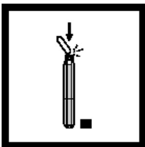
9. 将未开封的安培瓶放入酸消化瓶中，当安培瓶的刻度与酸消化瓶顶部平齐时，折断安培瓶的顶部，让其落入酸消化瓶。
