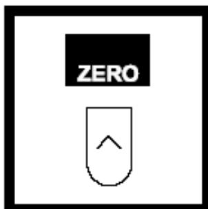
13. 当计时器显示 2:00, 按 ZERO, 屏幕显示：0  $\mu\text{g}/\text{L}$  CH<sub>2</sub>O。
