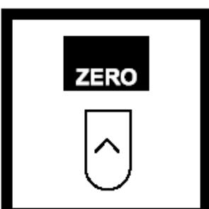
7. 按 ZERO, 屏幕显示: 0.00 mg/L PO<sub>4</sub><sup>3-</sup>
