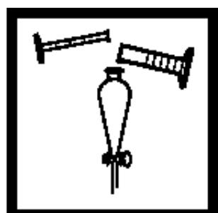
7. 加入30 mL双硫腙到分液漏斗中,盖好盖子,倒转。打开活塞通气。关上活塞,并加入5 mL的5.0 N氢氧化钠标准溶液,盖上盖子,倒转。打开活塞通气。关上活塞,摇晃漏斗一到两次,通气。
