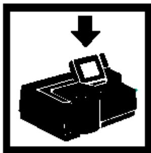
41. 将上一步得水样置于比色槽中，将会显示结果 $\mu\text{g}/\text{L}$  mercury，这是原水样的浓度。
