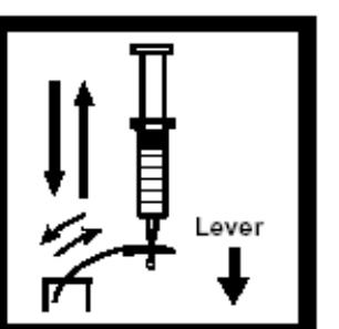
19. 阀门处于吸气档，吸入25cc去离子水清洗注射器和针筒，弃去水。
