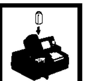
10. 将待测样品放入比色瓶槽，关上遮光盖。屏幕将显示总铁的含量，单位为mg/L。
