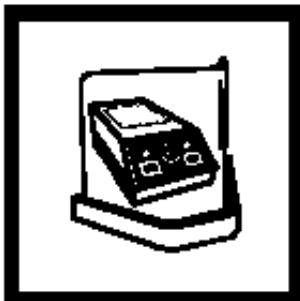
1. 开启COD反应器，加热到103~105 °C。将塑料罩放在反应器前面。
