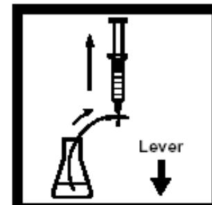
15. 通过管道吸入至少10 cc洗提液到注射器中，然后然后吸入少量空气，超过25cc刻度线。
