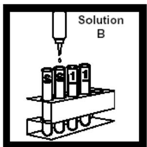
2. 开始2.5分钟计时，分别加入5滴溶液B到每个管中，混合，盖上盖子。
