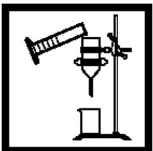
5. 倒入 50 mL 样品到滤器中，收集过滤过的样品。
