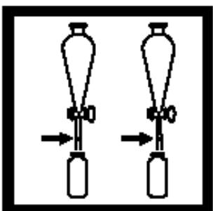
18. 分别在两个分液漏斗的出液管中塞入棉花，缓慢地将甲苯分出到相应的标记着“空白试样”和“样品”的比色管中，盖好比色管。
