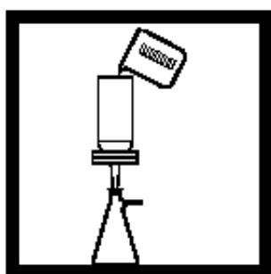
4. 倒出大约50mL原始样品溶液过滤，收集滤液，在过滤瓶上标记“原始液”。
