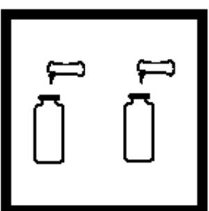
5. 分别加入一包Q.A.C. 试剂1粉包到每个管中, 旋转(不要摇晃)比色瓶使试剂溶解。
