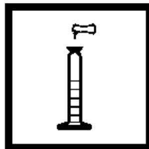
4. 将一包ZincoVer 5试剂药包加入量筒中, 塞好塞子。反转多次使粉末完全溶解。注意! 该步骤中的试剂含有氰化物, 取出试剂或吸入气体都是有毒的。不能加到酸性样品中 (<pH 4)。
