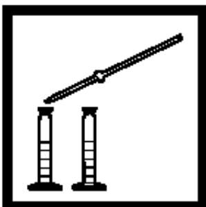
5. 当计时器鸣叫时，分别精确加入 1.00 mL 聚丙烯酸 2 试剂到每个量筒中，盖好盖子，混合。立即进行步骤6和7。
