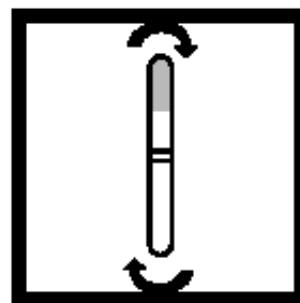
7. 立即不断翻转溶液直到抗体管被充满四次，酶联溶解。最后翻转时，确保溶液在抗体管中，抗体管朝上。
