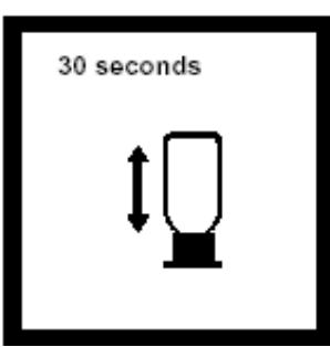
6. 不反转安培瓶, 立即将充满样品的安培盖稳放在安培瓶的尖端上。摇晃瓶约30秒。
