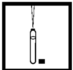
4. 用TenSette移液管加入5.0mL样品到另一个高含量反应磷的TNT瓶中（空白样品），盖好盖子，混合。
