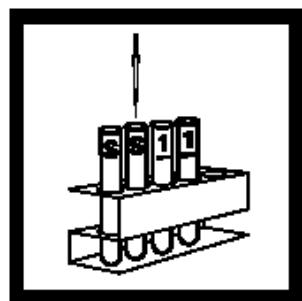
4. 用TenSette移液管和一个新的吸头分别加入0.5mL去离子水到每个管中，混合。
