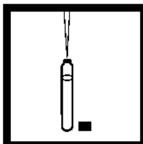
3. 用TenSette移液管加入5.0mL去离子水到一个高含量反应磷的TNT瓶中（空白样品），盖好盖子，混合。
