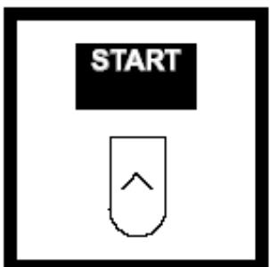
8. 按 START , 从780nm开始, 仪器将以5nm的间隔读出百分透光值(%T), 直到380nm。完成以后, 仪器将显示样品的泛黃度色度值。
