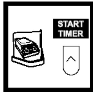
7、将试管置入 COD 反应炉，按 START TIMER 计时 30 分钟。
