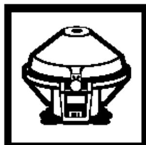
4. 使用“所需的物品与设备”中列出的实验室仪器过滤或离心25mL样品溶液。注: 离心比过滤更快。
