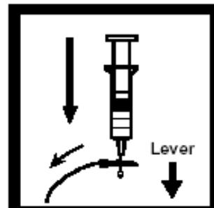
14. 摆晃冲洗注射器，通过管道弃去洗提液。
