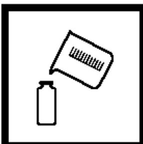
8. 往1英寸正方形比色瓶中装入调节过pH的过滤样品（样品），弃去多余液体。
