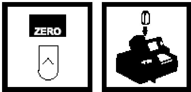
9. 按 ZERO, 屏幕显示: 10. 将待测样品放入比色瓶槽, 关上遮光盖。屏幕将显示铜的含量, 单位为 $\mu\text{g/L}$ 。
