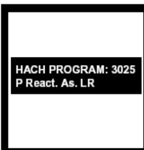
2. 屏幕显示: HACH PROGRAM: 3025 P React. As. LR, 波长自动调节为890nm。
