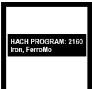
2. 屏幕显示：HACH PROGRAM: 2160 Iron, FerroMo，波长自动调节为590 nm。
