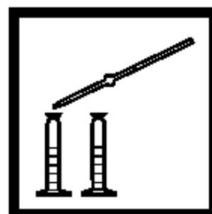
3. 分别精确量取 1.00 mL聚丙烯酸1 试剂到每个待测的混合量筒中，盖好盖子，混合。立即进行步骤4。
