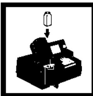
9. 将待测样品放入比色瓶槽, 关上遮光盖。屏幕将显示总铁的含量, 单位为 mg/L。
