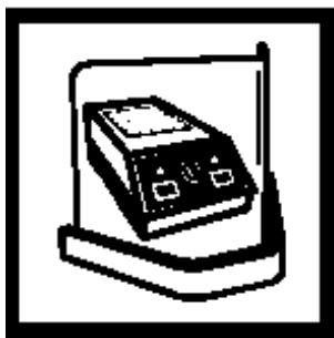
1、开启 COD 反应炉，加热至 103–106 °C，将塑料隔版置于反应炉前。
