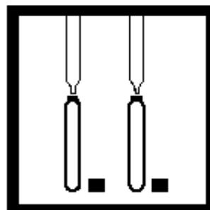
4. 移取1 mL样品到一个瓶中(样品), 移取1mL去离子水到另一瓶中(空白试样)。盖好瓶盖, 摆晃30秒混合。
