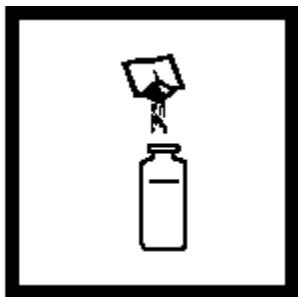
40. 在该水样中加入 HgEX6 铝箔包试剂，充分摇晃溶解。
