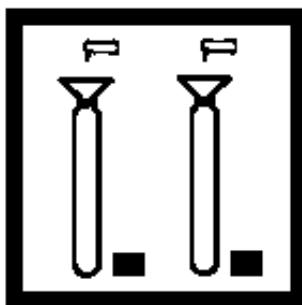
10. 用漏斗分别加入一包氨氯尿酸盐试剂粉包（用于5mL样品）到每个瓶中。
