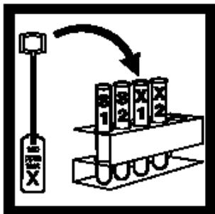
9. 用WireTrol移液管从100ppm稀释安培瓶中移取0.05mL稀释样品提取液加入到“样品1”和“样品2”的TPH酶联管中，充分混合。
