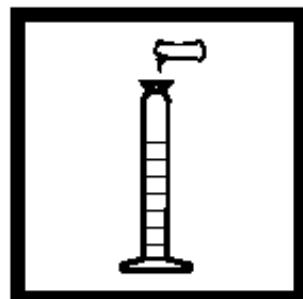
3. 各加入一包银1试剂粉包到一个干的50mL的混合量筒中。
