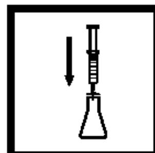
3. 插入活塞，推动样品流过滤器，并用50mL的锥形瓶收集滤液，瓶上标记“样品”。
