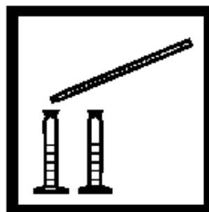
4. 选择消化样品的适当的分析体积, 分别移取分析体积量的样品和空白到相应的25mL混合量筒中。
