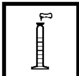
4. 加入一包FerroMo铁试剂1粉包到量筒中，盖好盖子，倒转多次使试剂溶解。此为待测样品。
