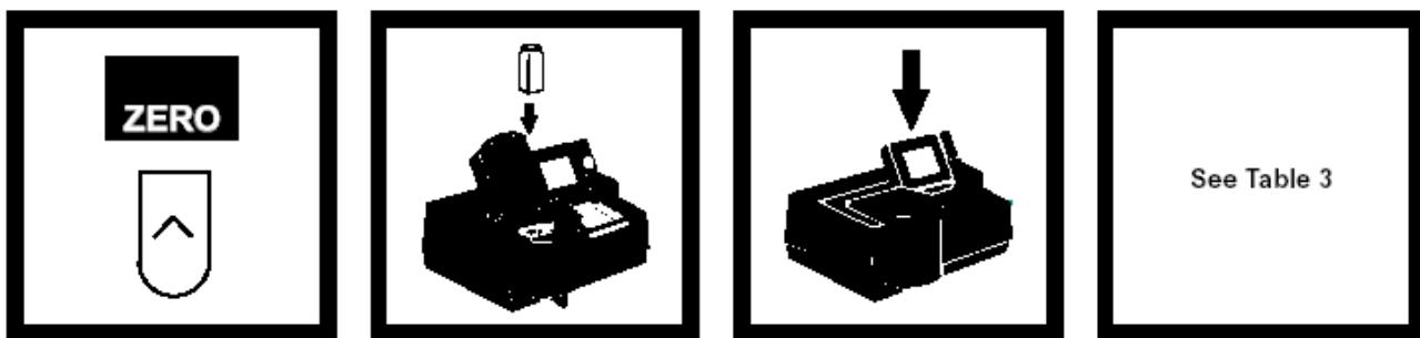
13. 按 ZERO, 屏幕显示: 0.00 mg/L PO<sub>4</sub><sup>3-</sup>
