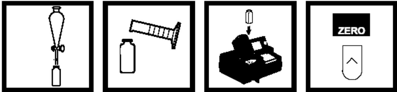
9. 将上层的苯溶液倒入一个干净的25mL比色瓶中(待测样品)。
