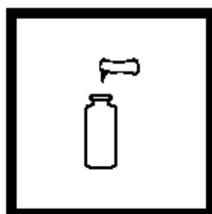
4. 加入一包NitriVer 2亚硝酸盐试剂粉包,盖上盖子,摇晃使溶解(待测试样)。
