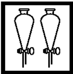
12. 取走盖子，让每个漏斗静置直到氯仿在下层分层。
