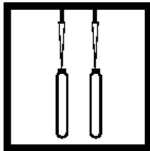
7. 用 TenSette 移液管分别加入 0.3 mL 不含有机物的水到试剂空白的瓶中，加入 0.3mL 待测试样到样品瓶中，混合。
