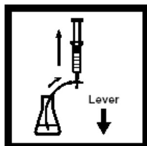
8. 将阀门转到吸气档（向下）。通过管道抽取5cc试剂空白到注射器中，吸入空气到30cc刻度线。
