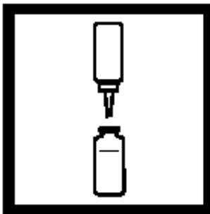
6. 分别加入 15 滴碱性氯化物试剂溶液到每个比色瓶中, 混合。
