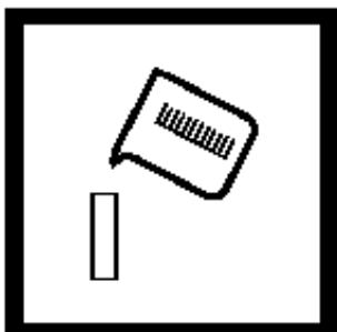
6. 用不含有机物的水清洗一个干净的 1-cm 石英比色皿几次。往比色皿中装入不含有机物的水(试剂空白)，擦净比色瓶壁。
