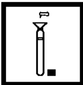
10. 用漏斗加入一包NitraVer X试剂B粉包到瓶子中。盖上盖子并倒转10次混合。(待测试样)。
