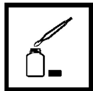
4. 打开 Bactrol inoculum 瓶盖, 用消毒镊子夹出一个 Bactrol Inoculum Disk。
