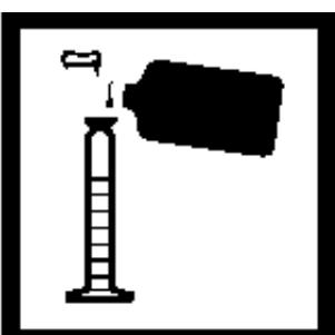
6. 往50 mL混合量筒中加入50mL氯仿。加入一包DithiVer金属试剂粉包。盖上盖子,反复倒转混合。往另一个量筒中倒入30mL双硫腙溶液。
