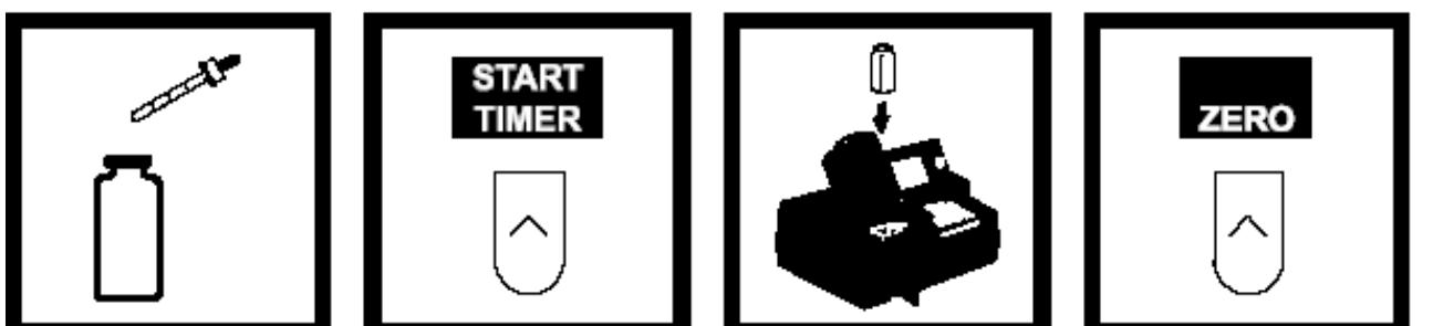
5. 在比色瓶中各加入 0.5 mL HydraVer 2 联氨试剂，混合。注：如果存在联氨将显示黄色。
