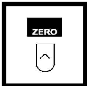
9. 按 ZERO, 屏幕显示: 0.0 mg/L PO<sub>4</sub><sup>3-</sup>
