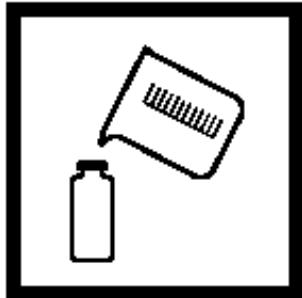
13. 往另一个比色瓶中装入25mL氯仿（空白试样），盖好盖子。将空白试样放入比色瓶槽，关上遮光盖。
