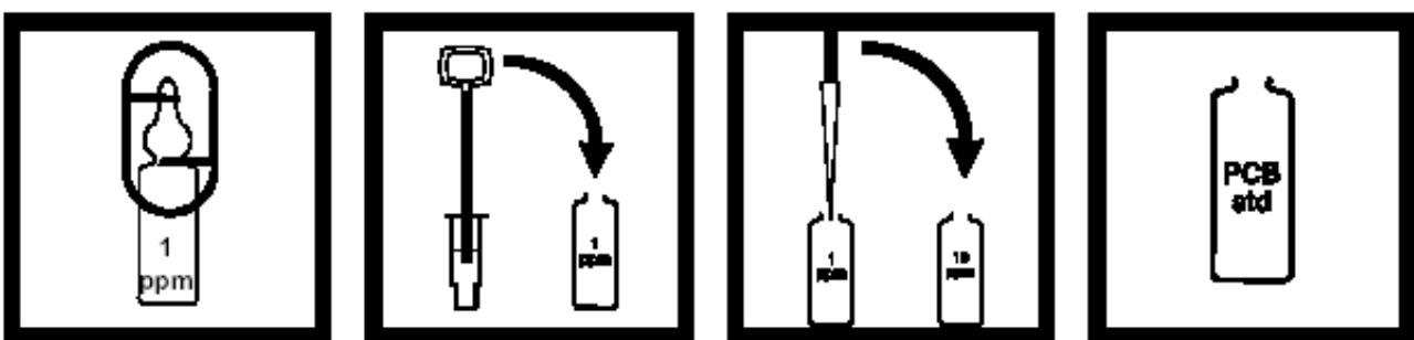
1. 准备一个1-ppm threshold dilution，打开一个1ppm 稀释安培瓶，做上相应的标记。
