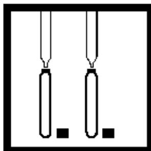
3. 分别移取1 mL 总无机氮预处理碱式浓缩液到两个总无机氮预处理稀释瓶中。
