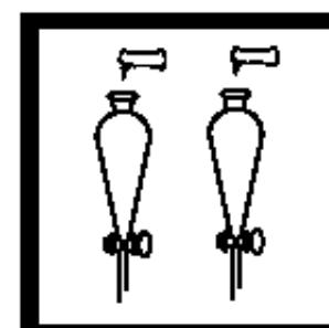
8. 分别加入一包苯酚试剂粉包到每个分液漏斗中，盖好盖子，摇晃使粉末溶解。
