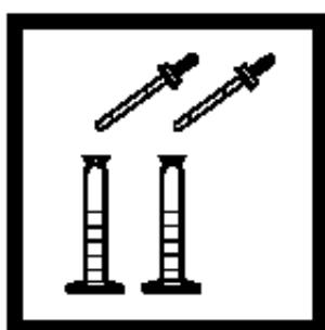
5. 分别加入一滴 TKN 指示剂到每个量筒中, 加入几滴 8.0 N KOH 到每个量筒中直到第一次闪现蓝色, 盖好盖子, 每次加入试剂后充分混合。
