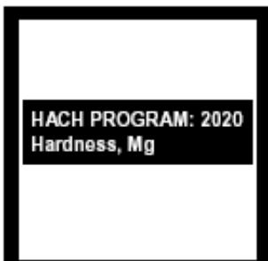
2. 屏幕显示: HACH PROGRAM : 2020 Hardness, Mg, 波长自动调节为522nm。
