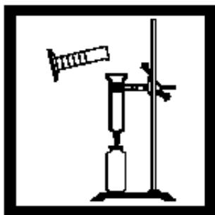
10. 将 25-mL 的比色瓶放在萃取器下，用 25-mL 塑料量筒加入 25mL pPb-3 洗提液洗提液到萃取器中。
