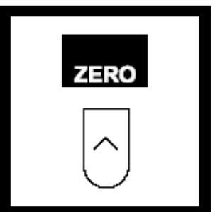
6. 按 ZERO , 从780nm开始, 仪器将以5nm的间隔为空白建立100%透光值, 直到380nm。屏幕显示: 0 YI。
