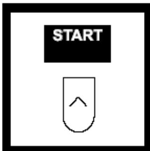
8. 按 START ，从780nm开始，仪器以5nm间隔读出百分透光值 (%T) ，直到380nm。完成后，仪器显示样品的三色激励色度值。
