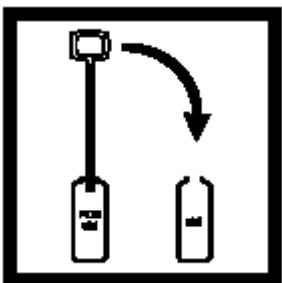
5. 用WireTrol移液管移取0.1mL标准溶液加入到1ppm稀释安培瓶中，充分混合。
