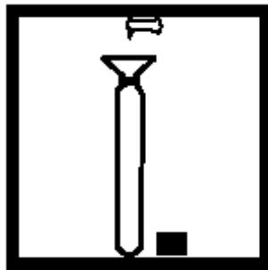
5、以漏斗加高锰酸钾试剂到试管。
