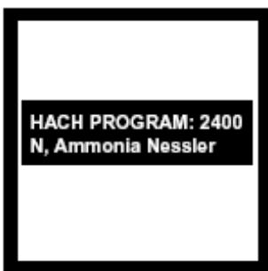
2、屏幕将显示 HACH Program: 2400N, Ammcnia Nessler 分析波长自动选择至 425nm。
