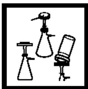
2. 装配过滤装置（膜过滤器，过滤器架，滤瓶和吸气瓶）。
