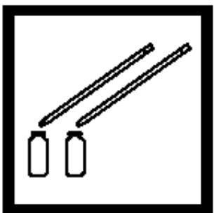
14. 加入 10mL 的去离子水到每个管。旋转混合。
