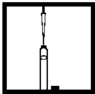
4、加 5mL 试样于试管中。注：可以 1.0mg/L 标准试样确认测试结果的精确度。
