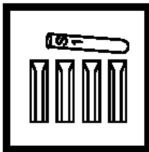
5. 对每个标准和样品的抗体管各标记一个1cm microcell。将标准管和比色瓶中的溶液倒入相应的1cm管中。
