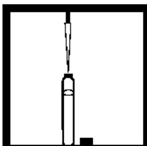
3. 用TenSette移液管加入5.0mL样品到一个反应磷TNT稀释瓶中, 盖好盖子, 混合。
