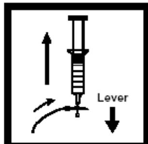
13. 再将阀门转到吸气档(向下)。通过管道吸入约5cc洗提液到注射器中，然后吸入少量空气，超过25cc刻度线。
