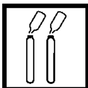
5. 从两个总无机氮还原剂安培瓶中分别倒出内容物到样品和空白的TIN稀释瓶中。注: 为了安全, 打开安培瓶时戴上手套。
