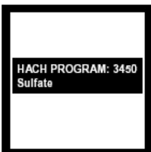
2. 屏幕显示: HACH PROGRAM : 3450 Sulfate, 波长自动调节为450 nm。
